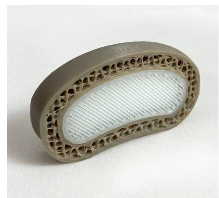
**Bild 7.** Kombiniertes spinal cage („Körbchen“) für den Zwischenwirbelraum) aus den Materialien Vestakeep (außen) und Resomer (innen) aus dem Kumovis-Drucker © Evonik
