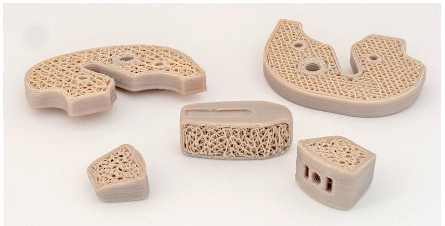
**Bild 5.** Mikroporöse Strukturen in einem 3D-gedruckten Werkstück, die das Anwachsen knochenbildender Zellen beschleunigen © Evonik
